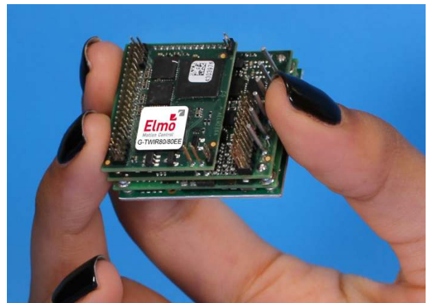
그림 5: 초소형 고출력 서보 드라이브: 80A, 80V
